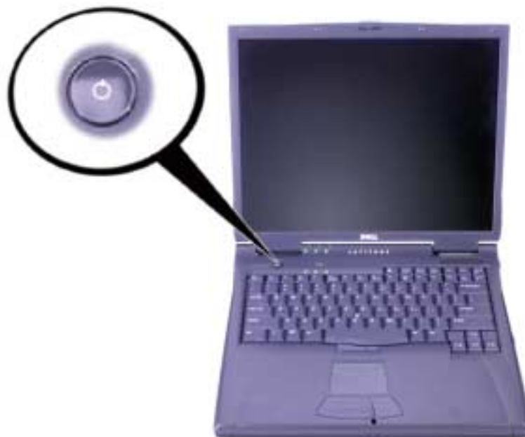
Figura 4-3. Encendido del ordenador
